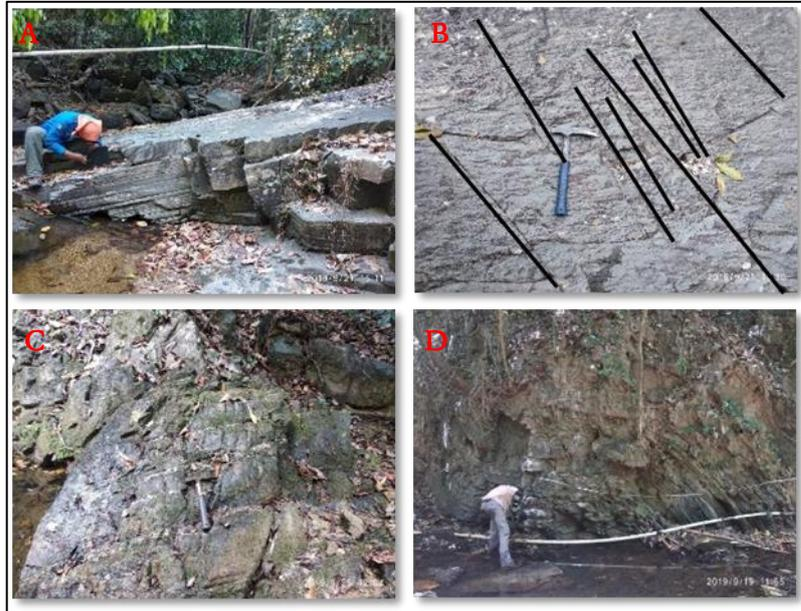
**Gambar 4** Singkapan pada daerah aliran sungai yang menunjukkan penciri struktur (A) Lapisan miring (B) kekar tarik (C) kekar gerus, dan (D) lipatan.
